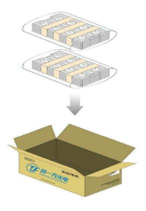
4.4)绝缘密封包裹, 尺寸: XXXmm x XXXmm)每箱一共 XXX 片模组, 重量 XXX KG
